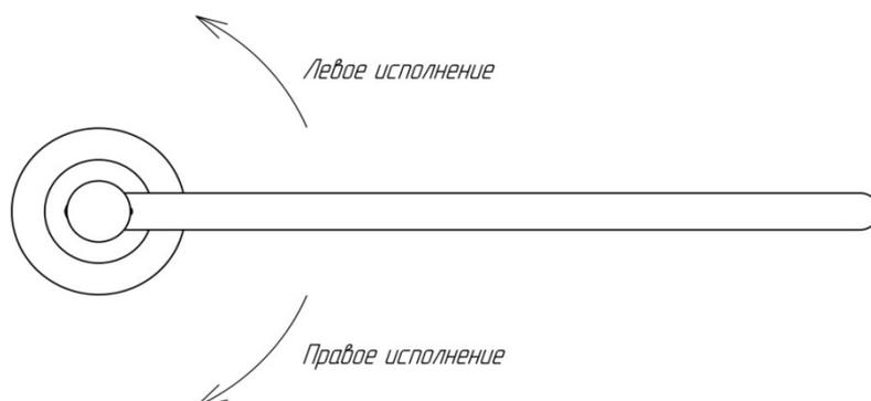
*Рис. 3. Определение варианта исполнения калитки*
